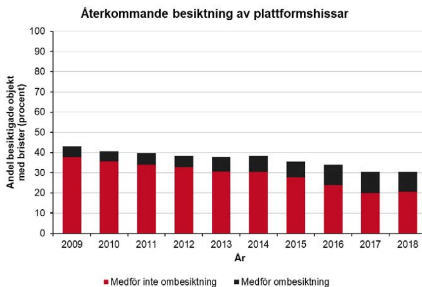
Figur 1.3.6b Andel besiktade plattformshissar med brister vid återkommande besiktning åren 2009–2018. Källa: Sammanställning från besiktningsverksamheten 2018. Klicka på bilden för att se den i större format. Illustration: Boverket
