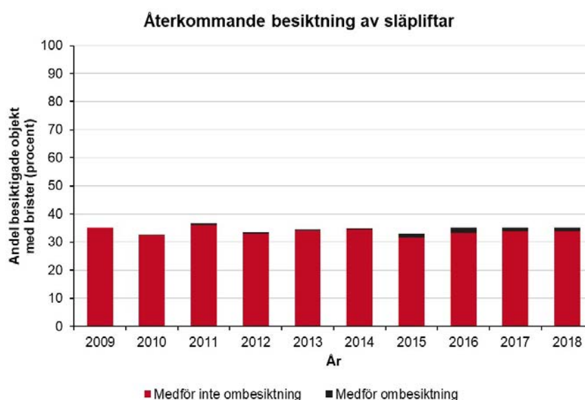
Figur 1.3.6h Andel besiktade släpliftar med brister vid återkommande besiktning åren 2009–2018. Källa: Sammanställning från besiktningsverksamheten 2018. Klicka på bilden för att se den i större format. Illustration: Boverket
