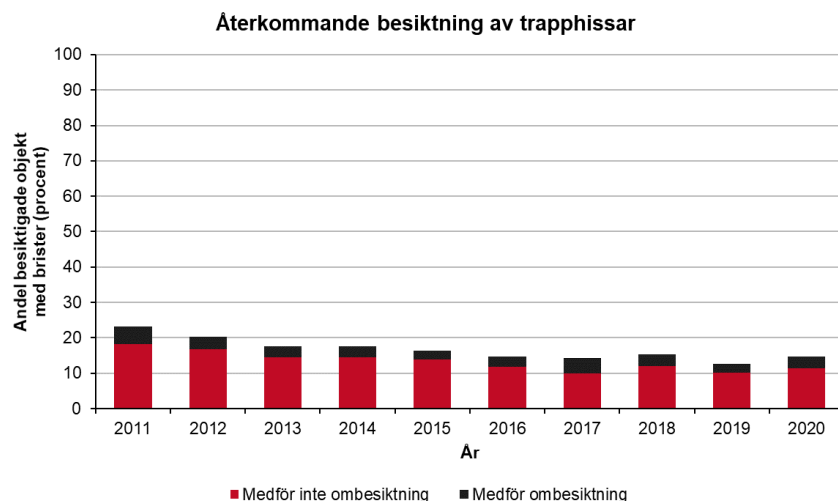
Figur 1.3.6c Andel besiktigade trapphissar med brister vid återkommande besiktning åren 2011–2020. Källa: Sammanställning från besiktningsverksamheten år 2011–2020. Klicka på bilden för att se den i större format. Illustration: Boverket
