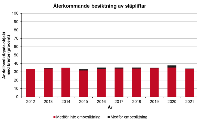
Figur 1.3.6h Andel besiktade släpliftar med brister vid återkommande besiktning åren 2012–2021. Källa: Sammanställning från besiktningsverksamheten år 2021. Klicka på bilden för att se den i större format. Illustration: Boverket
