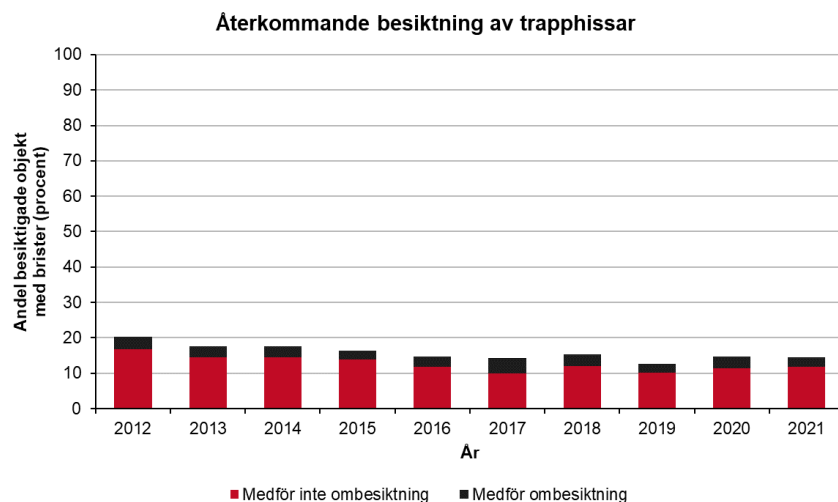
Figur 1.3.6c Andel besiktigade trapphissar med brister vid återkommande besiktning åren 2012–2021. Källa: Sammanställning från besiktningsverksamheten år 2021. Klicka på bilden för att se den i större format. Illustration: Boverket
