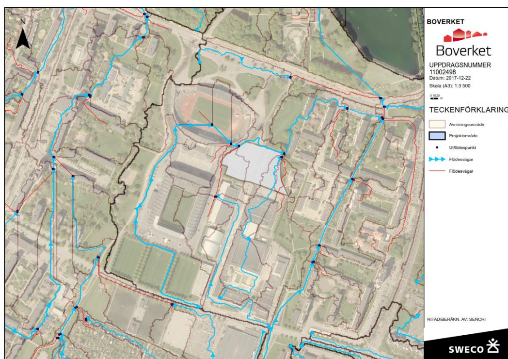
MIGr - Innerstaden 9:173: Visualisering av flödesvägar (blåa och röda) och utflödespunkter (svarta) i området enligt flödesberäkningar för ett 10 års-regn och GIS modellanalys.
